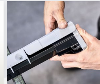
Napínač lemu střechy (pružinový) Řada 1 je vybavena patentovaným pružinovým napínacím zařízením. Střeška tak zůstává napnutá i po dlouhé době.
